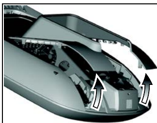
Рис. 9: Снятие кожуха доступа с консоли P80
