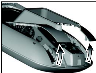
Рис. 16: Снятие кожуха доступа с консоли P80
