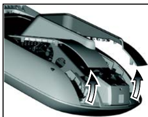
Рис. 8: Снятие кожуха доступа с консоли P80
