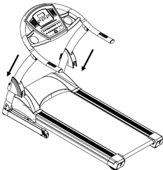
**Шаг 5.** Зафиксируйте боковые планки при помощи двух болтов (ST4\*15) с каждой стороны, затем вставьте крепления для бутылок в консоль. Сборка окончена.
