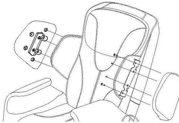
Закрепите подушки на металлических опорах с помощью винтов M8\*1.25P\*10L и M4\*0.7P\*10L.
