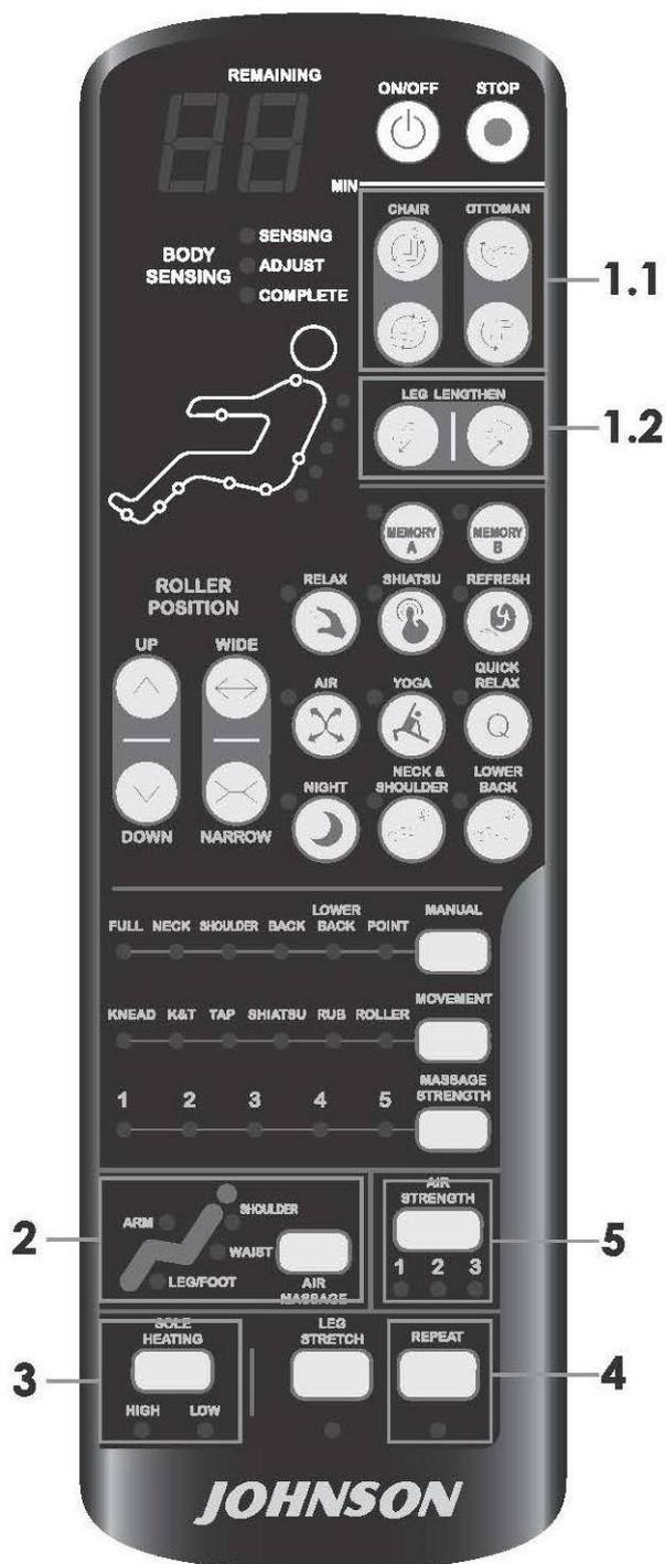
**1** Регулирование положения спинки и подножки.
