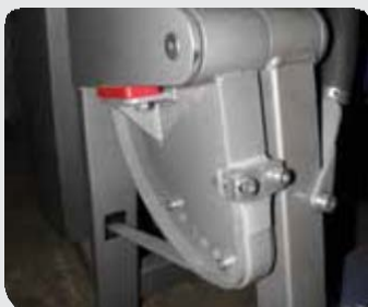
Система эксцентриков (Biosam) для создания оптимальной и правильной нагрузки на всей траектории выполнения упражнения
