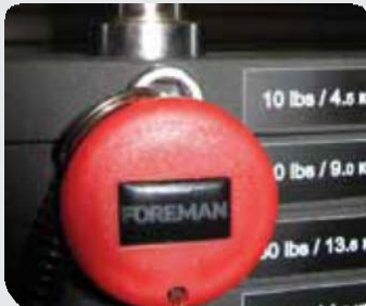
Pull Pin – пружинный механизм, фиксирующий положение подвижных частей тренажера
