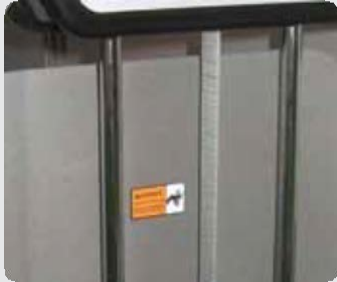
Полиуретановый ремень с 18 тросами из нержавеющей стали внутри
