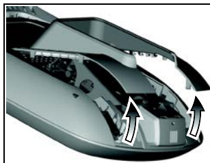
Рис. 24: Снятие кожуха доступа с консоли P80
