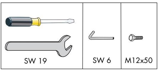
Zum Abziehen des Pedalarms entfernen Sie zuerst die Schutzkappe und Schraube (A). Halten Sie den Pedalarm fest und drehen Sie eine Schraube M12 (gehört nicht zum Lieferumfang) in die Gewindeöffnung (B). Nach einigen Umdrehungen können Sie den Pedalarm abnehmen (C).
