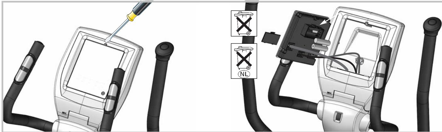
Eine schwache oder erloschene Computeranzeige macht einen Batteriewechsel erforderlich. Der Computer ist mit zwei Batterien ausgestattet. Nehmen Sie den Batteriewechsel wie folgt vor:
