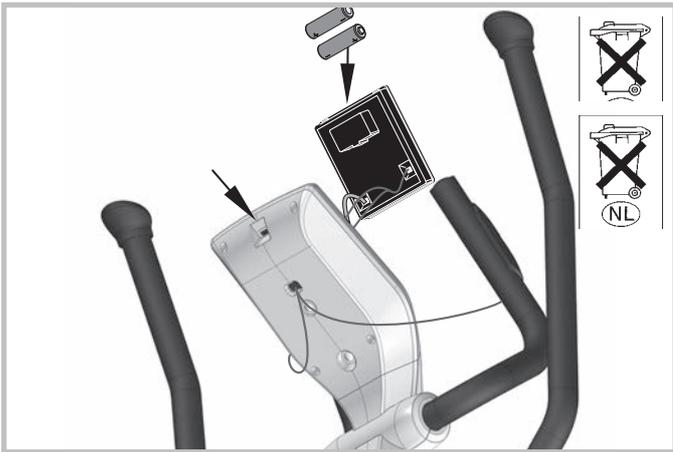
Eine schwache oder erloschene Computeranzeige macht einen Batteriewechsel erforderlich. Der Computer ist mit zwei Batterien ausgestattet. Nehmen Sie den Batteriewechsel wie folgt vor:
