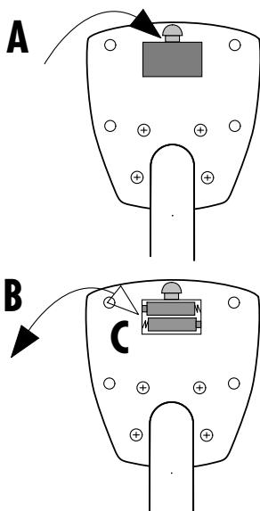
Eine schwache oder erloschene Computeranzeige macht einen Batteriewechsel erforderlich. Der Computer ist mit zwei Batterien ausgestattet. Nehmen Sie den Batteriewechsel wie folgt vor:
